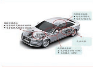
图 33: 线控底盤由多个子系统构成
